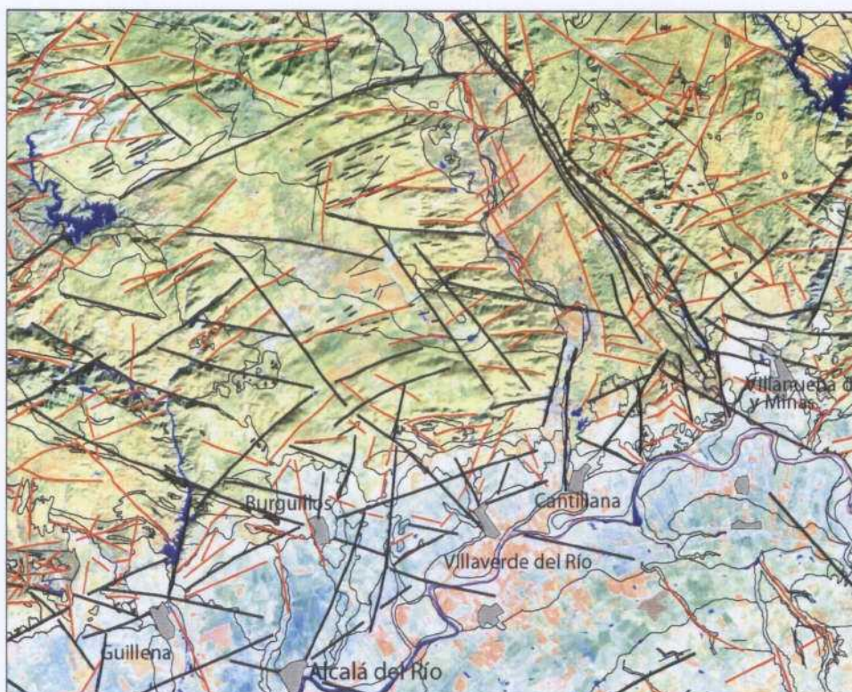
Figura 3. Imagen Landsat IHS mostrando las direcciones principales de fracturación
